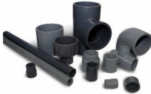
国标 UPVC 管材，依照 GB/T4219.1-2008(工业用硬聚氯乙烯管材)和 GB/T10002.1-2006(给水用硬聚氯乙烯管材)生产，国标 UPVC 管件，依照 GB/T4219.2-2015(化工用硬聚氯乙烯管件)和 GB/T10002.2-2008(给水用硬聚氯乙烯管件)；工业用管配件适用于输送长期温度在 45°C 以下某些腐蚀性化学流体和非饮用水等压力流体，给水用管配件适用于输送常温饮用水。
