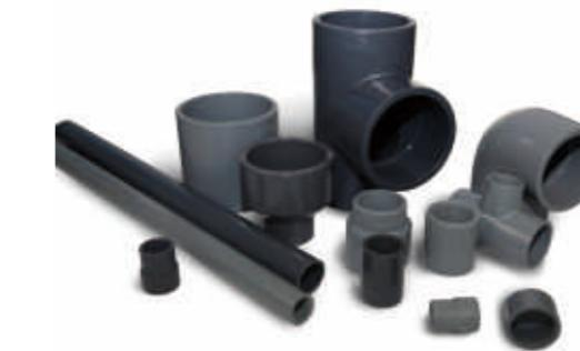
国标 UPVC 管材，依照 GB/T4219.1-2008( 工业用硬聚氯乙烯管材 ) 和 GB/T10002.1-2006( 给水用硬聚氯乙烯管材 ) 生产，国标 UPVC 管件，依照 GB/T4219.2-2015( 化工用硬聚氯乙烯管件 ) 和 GB/T10002.2-2008 ( 给水用硬聚氯乙烯管件 ) ；工业用管配件适用于输送长期温度在 45°C 以下某些腐蚀性化学流体和非饮用水等压力流体，给水管配件适用于输送常温饮用水。
